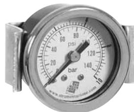
➤ Manometro standard, cassa ABS nera dn 63 mm, interni in ottone, classe di precisione 2,5%. Cassa metallica nera per strumenti per montaggio a pannello.
