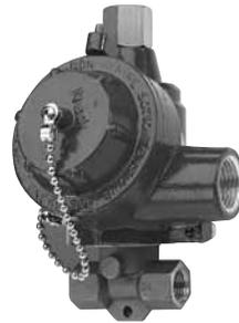
› Elettrovalvole tre vie due posizioni (3/2) a comando diretto con connessione da 1/4" adatte per il pilotaggio di attuatori e valvole a comando pneumatico a semplice effetto.
