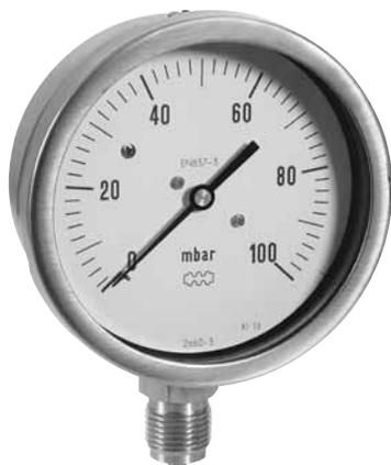
➤ Manometro a capsula per basse pressioni cassa inox, interni in ottone, attacco radiale, movimento in lega orologeria, classe di precisione 1,6% secondo EN 837-3, grado di protezione IP55.
