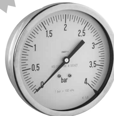
Manometro tutto inox, a secco oppure in bagno di liquido ammortizzante, DN 150, a molla tubolare da tubo trafilato senza saldature, cassa e anello in acciaio inox, attacco posteriore 1/2" in AISI316L, movimento in acciaio inox, classe di precisione 1% secondo EN 837-1, grado di protezione IP67, trasparente in vetro temperato. Possibilità di montaggio flangia anteriore (tipo E)
