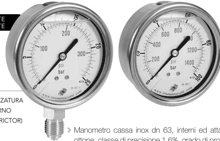
▶ Manometro cassa inox dn 63, interni ed attacco in ottone, classe di precisione 1,6%, grado di protezione IP67.
